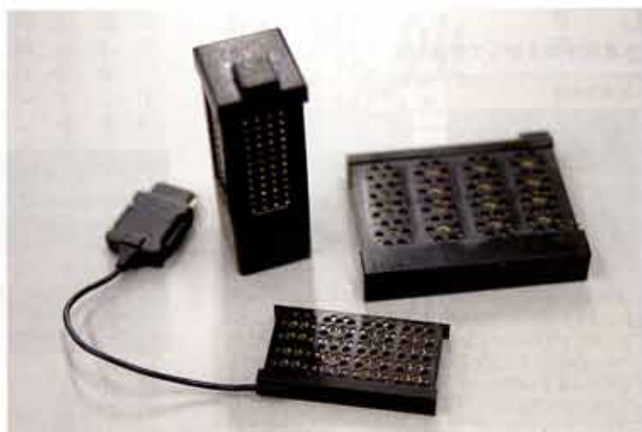
スティック型、フラット型などがあるマイクロ燃料電池の試作品。携帯電話、ポータブルゲーム機、音楽プレイヤーなど、用途にあわせて使い分けできるという。水素発生剤はカートリッジ化され、コンビニなどで市販する計画だ。
